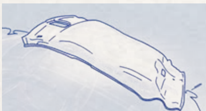
Unutarnja obloga krova
