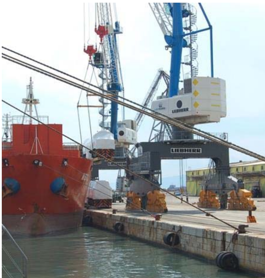
Slika 10. Nove obalne dizalice Liebherr za tzv. projektni teret ('Project Cargo')
